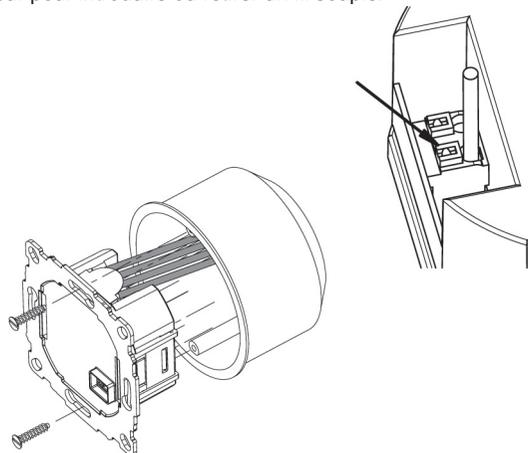
Les fils doivent être montés de manière à ce que les bandes en plastique servent d'isolation aux vis de fixation.
